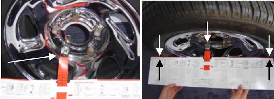
Die aufgeklappte Montageanleitung zum Reifen hin schieben, bis die **roten Kanten** der Montageanleitung das **Rad beidseitig berühren** (siehe Abb. rechts). Hierbei wird der Anzeiger langsam zurückgeschoben. Nun können Sie den Abstandswert ablesen.
