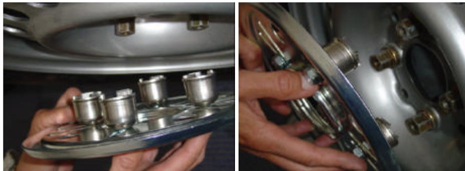
Die so vormontierte Metallscheibe mit den 3-armigen Halteklammern auf die Radschrauben /-muttern aufsetzen, bis alle Halteklammern passen und fest andrücken. Wenn notwendig, an den Schrauben drehen, um ein Aufdrücken auf die Radschrauben/ -muttern zu ermöglichen. Mit einer Hand die Adapterscheibe gleichmäßig andrücken und Schrauben von Hand anziehen. Weiter mit **„Festziehen“**(siehe unten).
