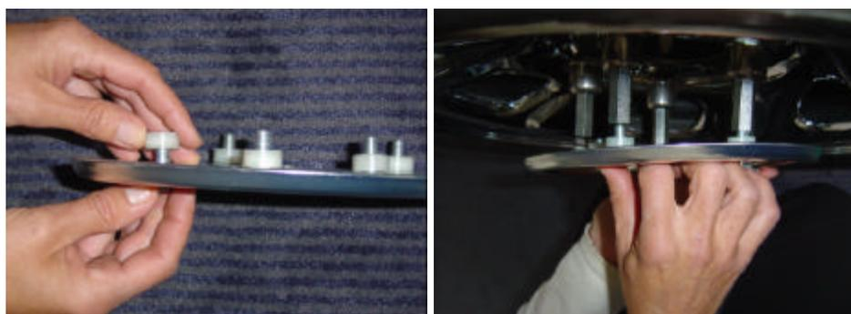
Wiederholen Sie den Vorgang gemäß **„Schraubenanordnung“** (siehe unten). Die so vormontierte Metallscheibe **D**, zum Rad hin auf die Rad-schrauben /-muttern
