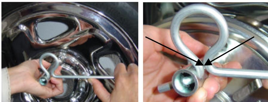
Den Rohrschlüssel auf der Schraube leicht festhalten, um ein Abrutschen oder schiefes Festziehen zu vermeiden. Drehen Sie nun mit dem Drehmomentstab im Uhrzeigersinn jeweils die 6-kantige
