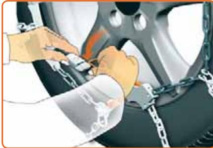
Nun müssen nur noch die beiden Ösen (9) in die Kunststoffhaken des Gummispanners (10) eingehängt werden.
