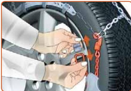
Zur Demontage stellen Sie Ihr Auto so ab, dass der orange Haken (4) so am Rad zum Stehen kommt, wie es die Abbildungen rechts zeigen. Haken Sie dann die beiden Ösen (9) am Gummispanner (10) aus.
