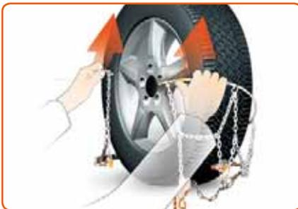
Greifen Sie die beiden Enden des Seilrings und ziehen Sie diese entlang der Reifen-Laufläche nach oben.
