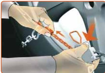
Nun die Spannkette lösen. Dazu drücken Sie den Entriegelungsknopf an der Ratsche (6) und ziehen die Kette zurück. Wiederholen Sie diesen Schritt an der zweiten Ratsche.
