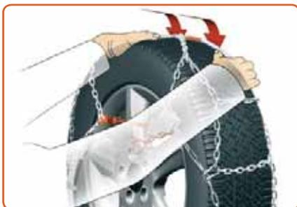
Schieben Sie den Seilring über die Lauffläche, bis er auf der Rückseite des Reifens zum Liegen kommt. Das rechte Bild zeigt die nicht sichtbare innere Reifenflanke und den korrekten Sitz.
