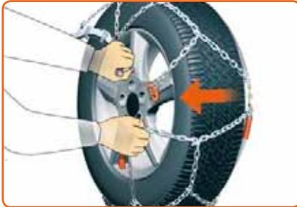
Fassen Sie das Laufnetz (11) im Bereich des orangefarbenen Hakens und an der Spannvorrichtung an. Ziehen Sie es zum Mittelpunkt des Rades. Der Verschluss (3) kommt jetzt nach vorn. Öffnen Sie den Verschluss!
