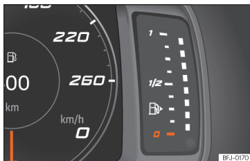
Afb. 61 Digitaal instrumentenpaneel: brandstofmeter.
