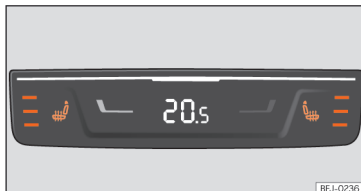
Afb. 151 Achter in de middenconsole: schakelaars voor stoelverwarming voor de achterstoelen.
