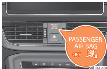
Afb. 18 Dashboard: controlelampje voor buiten werking gestelde bijrijdersairbag.
