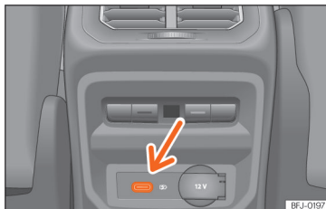
Afb. 163 Achterzijde middenconsole: USB-aansluitingen met functie van stroomvoorziening.
