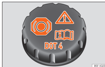
Afb. 249 Motorruimte: dop van het remvloeistofreservoir.
