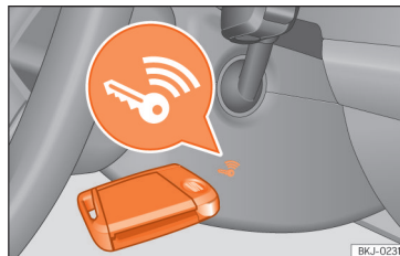
Afb. 165 Rechts van de stuurkolom: noodstart.
