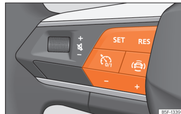
Afb. 182 Op het multifunctiestuurwiel: knoppen voor bediening van de snelheidsbegrenzer
