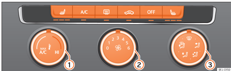
Afb. 148 In de middenconsole: knoppen voor de handbediende airconditioning.
