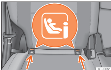
Afb. 26 Buitenste stoelen van de tweede zitrij: ISOFIX/i-Size-bevestigingsbeugels.
