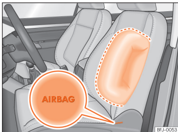
Afb. 21 Zij-airbag in de bestuurdersstoel.
