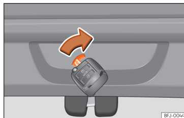
Afb. 88 Detail van de bagageruimte: noodontgrendeling.
