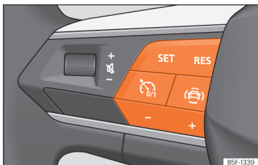
Afb. 181 Op het multifunctiestuurwiel: knoppen voor bediening van het snelheidsregelsysteem
