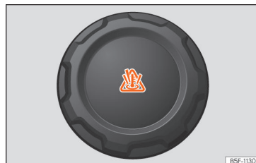
Afb. 248 Motorruimte: vuldop van het koelvloeistofexpansiereservoir.
