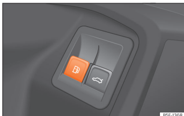
Afb. 235 Bestuurdersportier: ontgrendeling van de tankklep.
