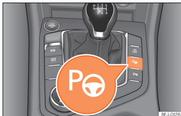
Afb. 202 Boven in de middenconsole: toets om het inparkeersysteem in te schakelen.
