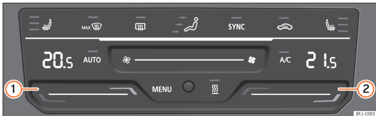
Afb. 147 In de middenconsole: bedieningselementen van de Climatronic.
