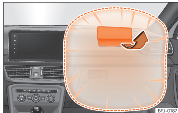
Afb. 16 Bijrijdersairbag in het dashboard.
