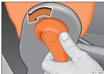
Afb. 114 Inklapbare rugleuning van de bijrijdersstoel ontgrendelen.
